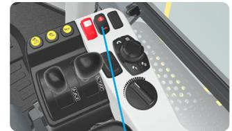
Interrupteur de verrouillage de l'équipement de travail
