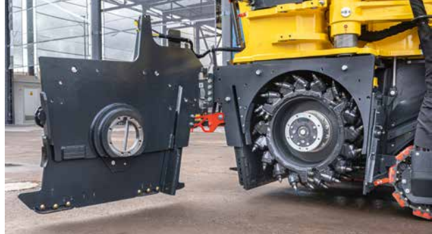
Protection anti-usure interchangeable en métal dur du carter et du tambour de fraisage.
