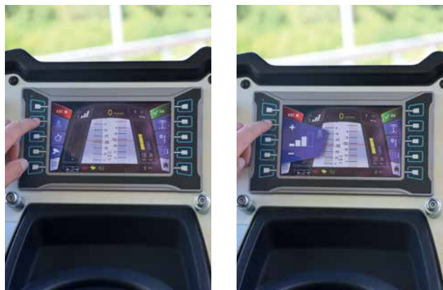
Tout est clair : le réglage du débit d'eau apparaît dans une fenêtre pop-up.
