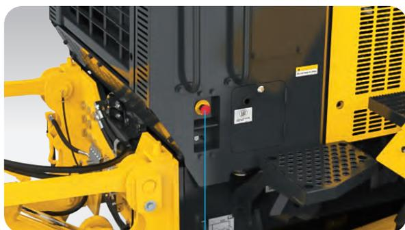
Interrupteur d'arrêt d'urgence du moteur
