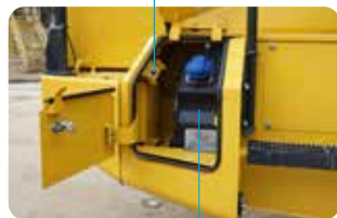
Réservoir de fluide d'échappement diesel (FED)
